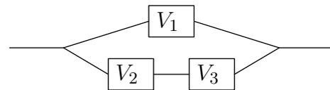
Le circuit est en état de marche si  $V_1$ , est en état de marche ou si  $V_2$  et  $V_3$  le sont simultanément.
